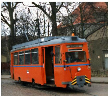
Triebwagen 44, nun als Arbeitstriebwagen 553, befährt am 28.3.1991 das Zufahrtsgleis zum Betriebshof Fahnenstraße. Gut sichtbar ist die Aufhängungsvorrichtung für den Schneepflug.
