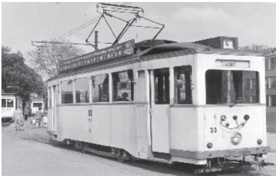
Triebwagen 33 nach dem Umbau mit Schiebetüren und verändertem Dach am 10.09.1967 in der Kuppelstelle am Steintor.
